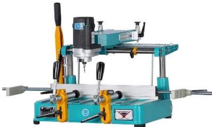
Esta máquina se utiliza para los procesos de fresado y la perforación de orificios de los ranura de cilindro, canales de drenaje de agua, bisagras y cerraduras de las ventanas y puertas de los perfiles de aluminio /PVC.
